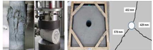
그림 2 콘크리트 압축·인장 및 균열성상 실험
