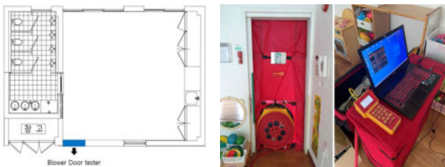
그림 1. 블로어도어 설치 위치와 실험사진
